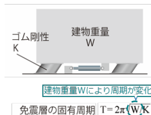
図1 積層ゴム免震とSSBの固有周期
